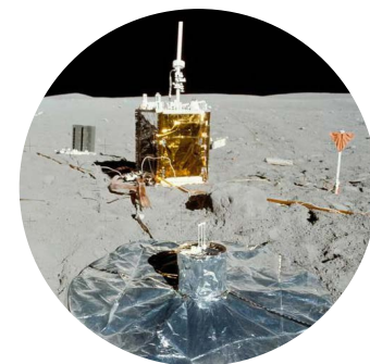
宇航员在舱外活动中展开的月面试验装置。前景中间是被动地震试验仪，背景中间是“阿波罗月面实验装置”，右边像旗子一样固定在地面的是主动地震试验仪。
